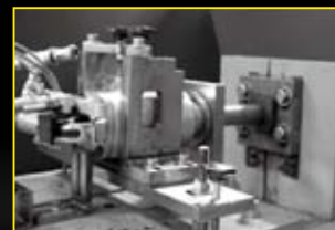
Zkouška pevnosti na utahováku
